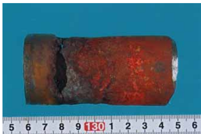
硫酸腐食によって減肉したチューブ
